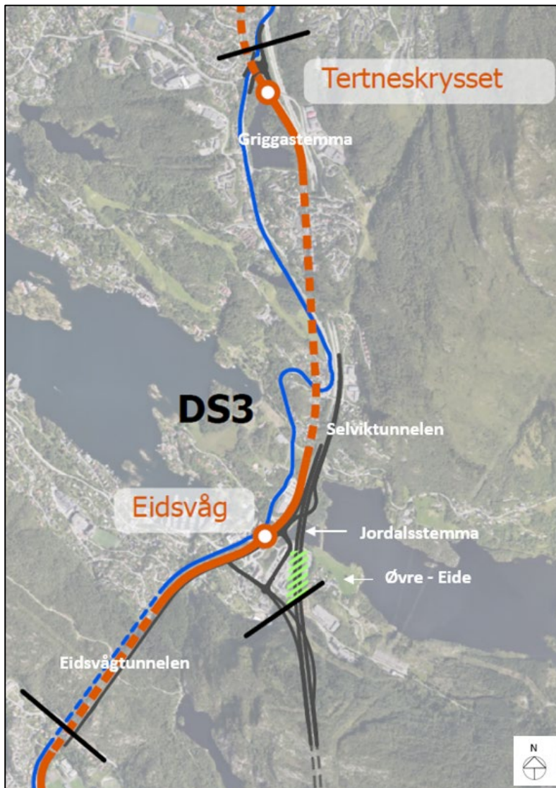
Figur 14 Illustrasjon over delstrekning DS3. Oransje linje er bybane, blå er gang-sykkel, grønn er miljølokk og svart er E39 og omlagt veganlegg.
